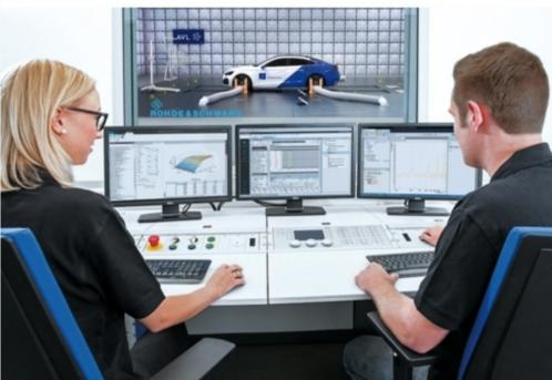
AVL et Rohde & Schwarz ont développé une solution de test automatique qui, par simulation, reproduit des conditions de conduite réelles tout en couvrant les normes spécifiques à l'automobile. La plateforme d'automatisation Puma 2 d'AVL contrôle le cycle de test et stocke les données mesurées. Celle-ci est synchronisée avec le logiciel R&S Elektra dédié au [...]
